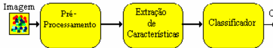
Figura 2. Sistema que realiza pré-processamento, extração de características e classificação de imagens.
