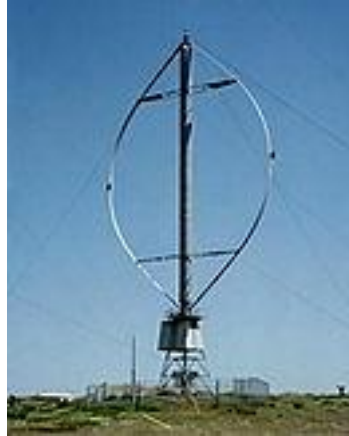
Figura 2. Aerogerador de Eixo Vertical
