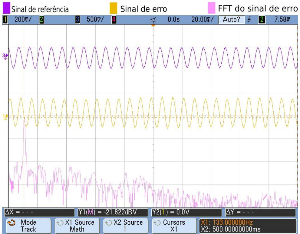
**Figura 18.** Ruído senoidal de 133 Hz com o sistema desligado
